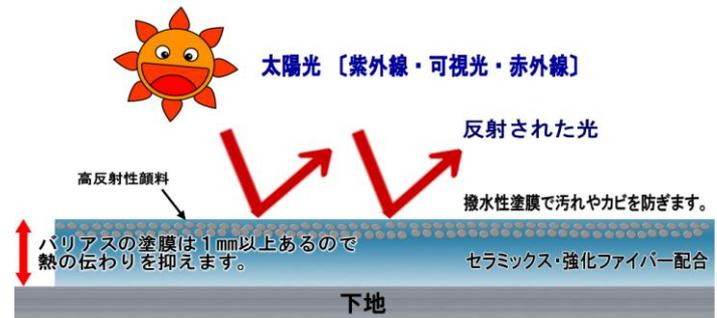
遮熱・断熱塗材 バリアスの仕組み
